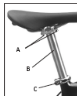
Figure 16 - Pièces composant la selle A - Boulons de fixation de la selle B - Tige de selle C - Boulon du collier de la tige de selle
