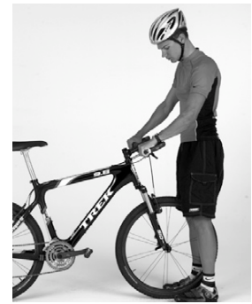
Figure 7 - Test fonctionnel du cintre et de la potence
