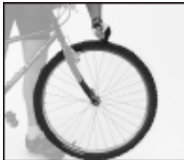
Figure 39 - Test pour vérifier la fixation des roues
