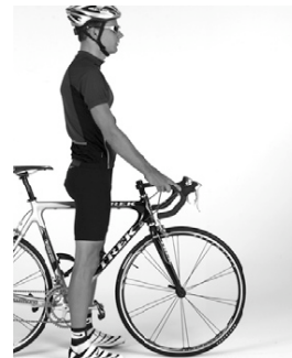
Figure 1 - Hauteur en surplomb minimale A = 25 \text{ mm} pour la plupart des vélos 50 à 75 mm pour les VTT
